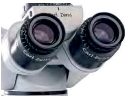
Окуляры с широким обзором обеспечивают большое поле зрения и трехмерное изображение
